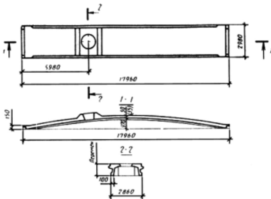
С двумя проемами диаметром 400, 700, 1000 или 1450 мм
